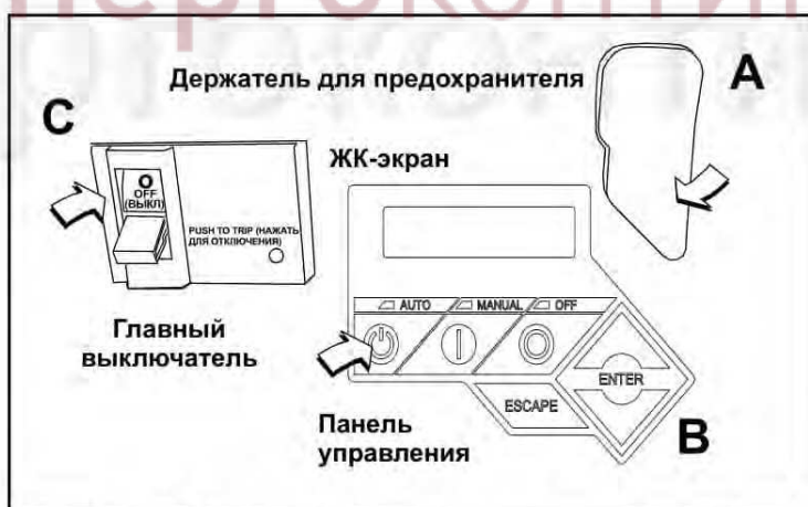
Рис. 5-16. Панель управления генератора
