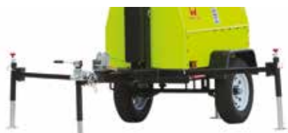
Четыре стабилизирующих опоры, которые складываются вручную для транспортировки
