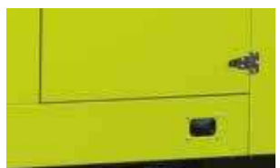
Отверстия для топливных трубопроводов
