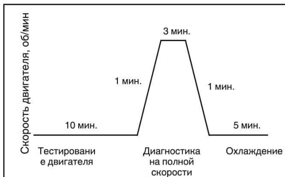
Рис. 2-1 Цикл тестирования без нагрузки
