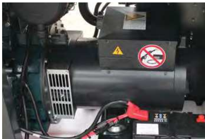
Альтернатор с перегрузочной способностью по току 300 % в течение 20 секунд
